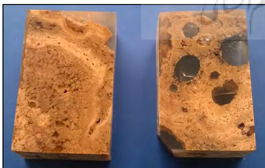
شکل ۴: برش بیسکویت‌های اشباع شده با رزین اپوکسی از طریق سیستم خلأ
