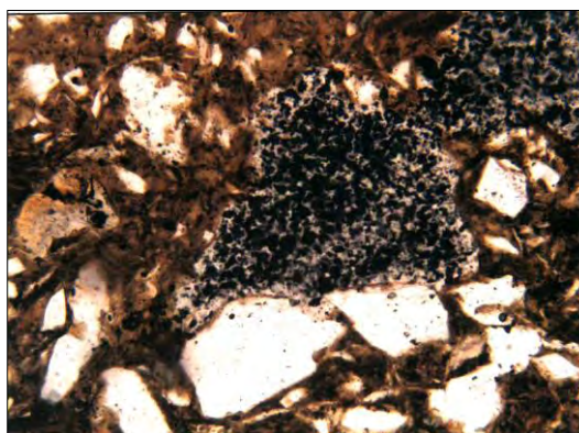
شکل ۱۵: دانه‌های کاربوراندوم که به داخل حفرات یک مقطع نازک سفال پیش از تاریخی در روند نازک‌کاری و پولیش نفوذ نموده‌اند و قبل از الصاق پوشش به سطح، از آن جدا نشده‌اند [13]. Fig; 15: Carborundum grit particles that have accumulated in voids during polishing and were not removed before cover slipping [13].
