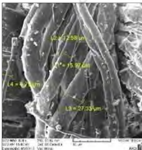
شکل ۹: تصویر SEM از الیاف کاغذ با بزرگنمایی ۸۰۰ برابر Fig: 9: SEM of paper-800X
