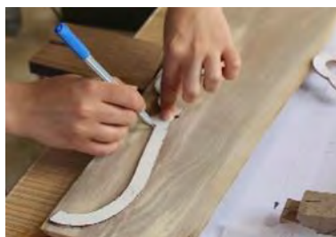
تصویر ۹- انتقال الگو بر روی چوب
