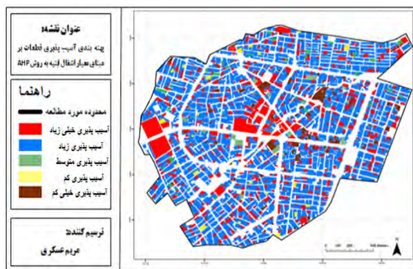
نگاره ۸: پهنه بندی آسیب‌پذیری ساختمان‌ها به روش AHP بر مبنای معیار سطح اشغال ابنیه
