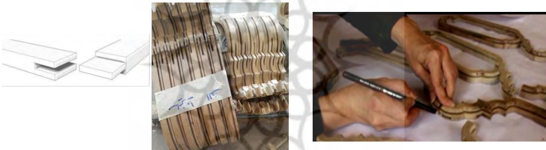
تصویر ۱۶- نمونه ای از اتصال فاق و زبانه
