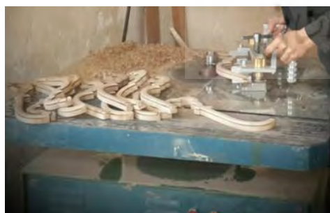
تصویر ۱۳- ایجاد شیار شیشه بر روی آلت ها
