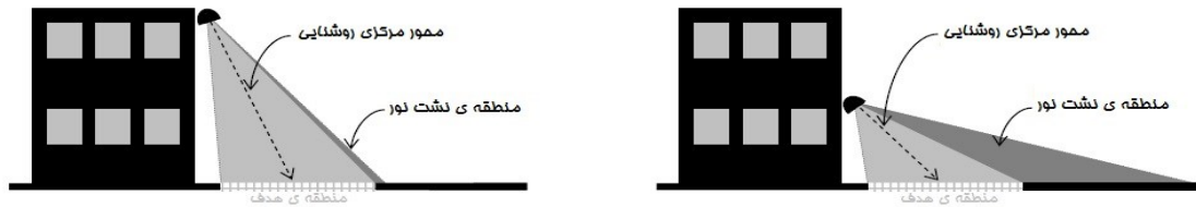
تصویر ۳: کنترل نشت نور با تنظیم زاویه و ارتفاع تیر چراغ (Laster, 2010, p20)
