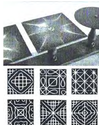
شکل ۹: شکل‌گیری نقش‌های متنوعی از ماسه‌ها توسط نوسان‌های حاصل از ارتعاشات ویولن؛ منبع: Jermokka, 2009: 21.
