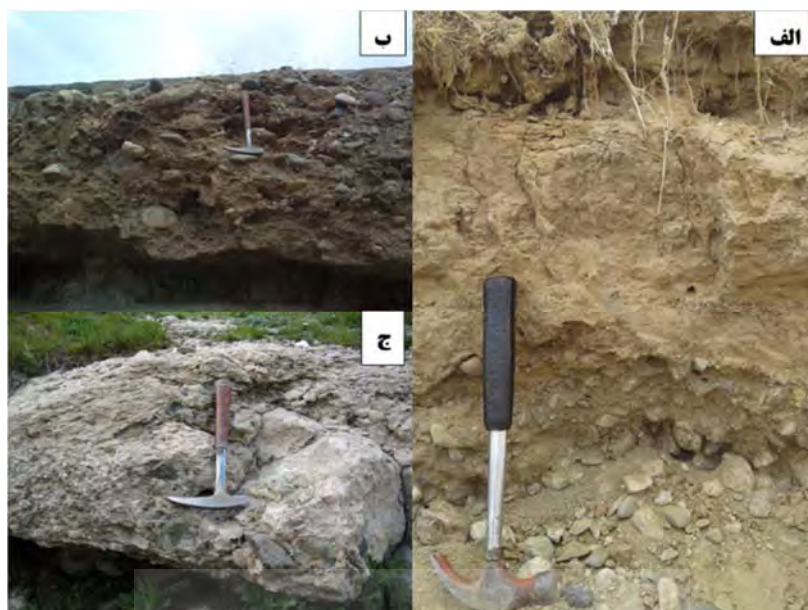
شکل ۲. الف) رسوبات منفصل و جدید دشت سیلابی: نمونه GL، ب) پادگانه سخت شده رودخانه‌ای با سیمان کلسیتی: نمونه SR و ج) پادگانه سخت شده رودخانه‌ای در کنار واحد کربناته آهکی: نمونه PH. (بخش گراولی و ما سه‌ای نمونه‌های برداشت شده مورد بررسی قرار گرفتند). موقعیت نمونه‌ها در شکل ۱ آورده شده است.
