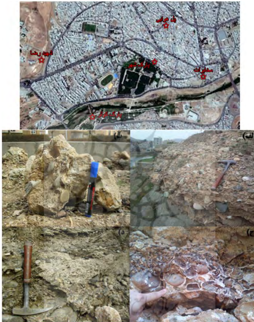
شکل ۳. کنگلومراهای سخت شده رودخانه‌ای الف) یادگانه بارک کوثر: رسوبات سخت شده با پوسته کربناتی و جهت رسوب‌گذاری مشخص (ایمبریکا سیون)، ب) یادگانه دبیرستان شهید رضا: رسوبات سخت شده با قطعات گراولی ریزودرشت سیمانی شده، ج) یادگانه مخابرات: کراست‌های کربناتی با رنگ روشن در پس‌زمینه گراول‌های رودخانه‌ای، د) یادگانه پل هوایی: رسوبات سخت شده با قطعات گراولی تخریبی و آتشفشانی
