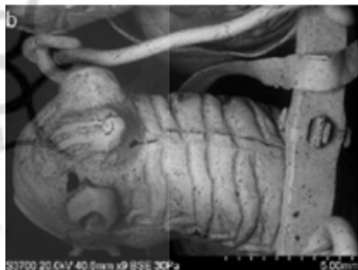
تصویر ۵- جزئیات لحیم کاری شده‌ی شکاف‌های متصل ورقه‌های طلائی اشکال (a) سر مسافر و (b) یال یکی از
