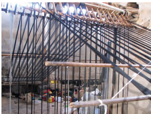
تصویر (۷) دستگاه بافندگی افقی چند ورد با وزنه (مأخذ: نگارنده)
