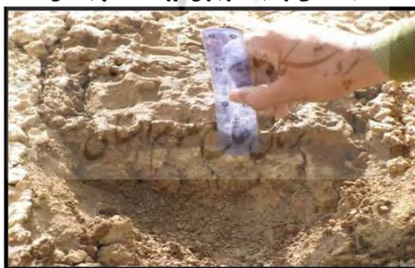
شکل ۴: اندازه‌گیری عمق نفوذ آب بارش در خاک.
