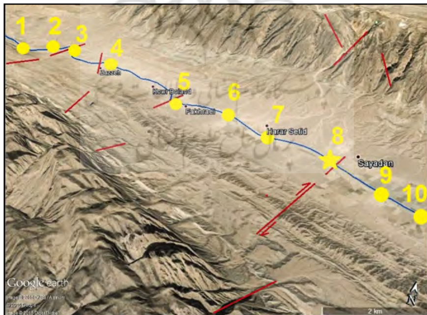
شکل ۹: جابه‌جایی لایه‌های سنگی در دامنه شمالی تاقدیس وراوی. (تصویر ماهواره‌ای از نرم‌افزار Google Earth)
