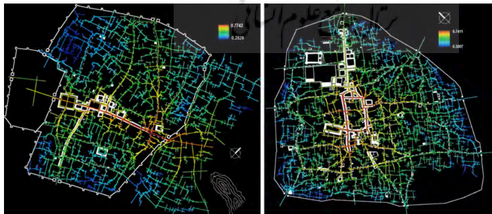
تصویر ۲: تحلیل توپولوژیک ساختار شهر قدیم شیراز (راست) و کرمان (چپ)، بازار به‌عنوان ستون فقرات ساختار هر دو شهر خودنمایی می‌کند (Karimi 1998, 160 & 161).
