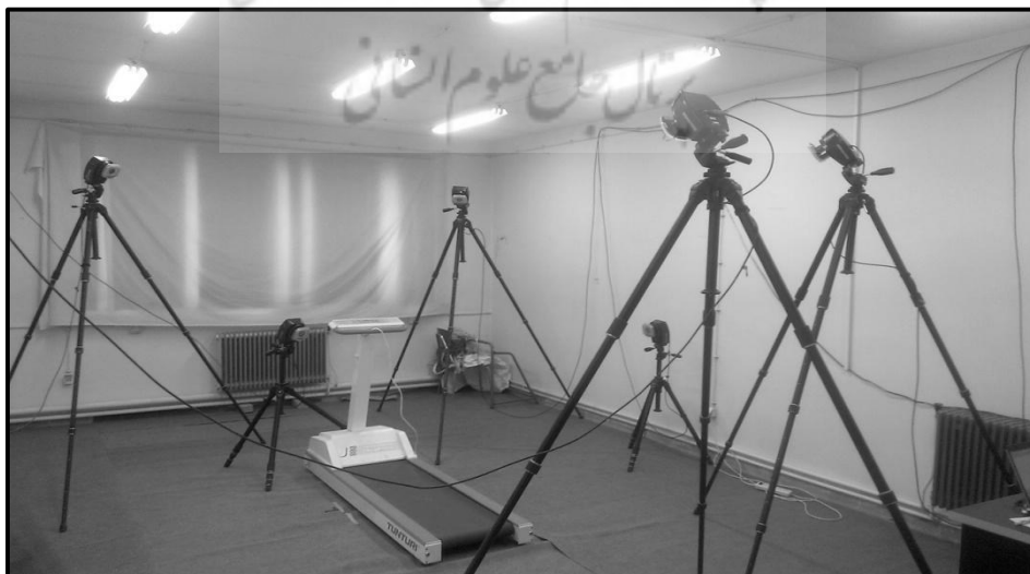
شکل ۱. موقعیت شش دوربین اپتوالکترونیک نسبت به تردمیل
