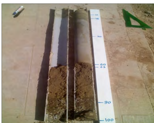
شکل ۸: تصویر ستون تزریق شده در دو تکرار آزمایش تثبیت بیولوژیکی
