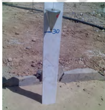
شکل ۷: به ترتیب از راست: نفوذ سمبه در ماسه تثبیت نشده، رهاسازی سمبه از فاصله ۳۰ cm، ناتوانی گوه در نفوذ به ماسه تثبیت شده با بایوتکنولوژی
