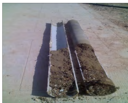
شکل ۸: تصویر ستون تزریق شده در دو تکرار آزمایش تثبیت بیولوژیکی
