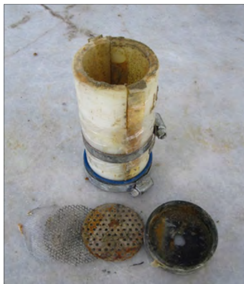
شکل ۶: قالب استوانه‌ای PVC و نمونه ماسه‌ای بهسازی شده آماده جهت آزمایش مقاومت تک‌محوره
