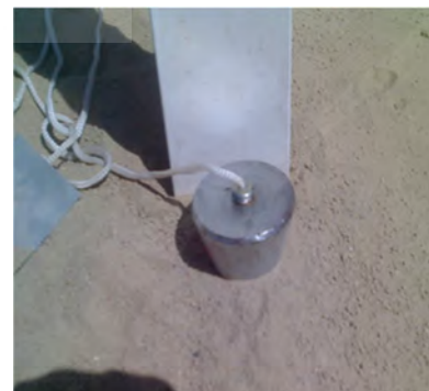
شکل ۷: به ترتیب از راست: نفوذ سمبه در ماسه تثبیت نشده، رهاسازی سمبه از فاصله ۳۰ cm، ناتوانی گوه در نفوذ به ماسه تثبیت شده با بایوتکنولوژی
