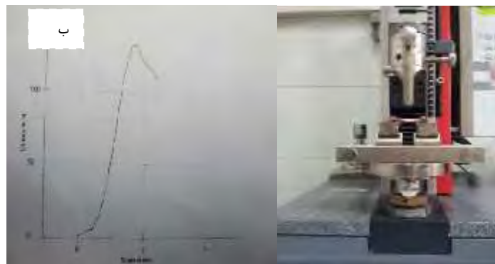
شکل ۲- الف. اندازه‌گیری پارامترهای بیومکانیکی به وسیله دستگاه نیروی خمشی سه‌نقطه‌ای. شکل ۲- ب. نمونه‌ای از منحنی تنش - کرنش.
