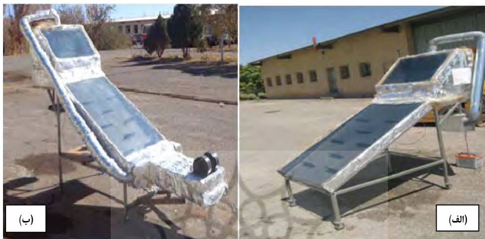
شکل ۱) خشک‌کن خورشیدی مورد استفاده در پژوهش الف) بدون سامانه بازیافت حرارت و ب) مجهز به سامانه بازیافت حرارت
