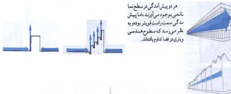
شکل ۹- تمهیدات کاهش تداوم افقی و عمودی فرم ساختمان، ماخذ (هدمن و یازوسکی، ۱۳۸۷)
