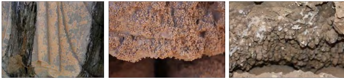
شکل ۱۲: سخت شدگی آهکی و تشکیل کربنات کلسیم بر روی سنگ، مجموعه‌ی میراث جهانی تخت سلیمان (پیرک، تابستان ۱۳۹۰) - تشکیل رسوب کربناته بر روی نقش برجسته‌ی کاخ اختصاصی (P) مجموعه‌ی میراث جهانی پاسارگاد (پیرک، زمستان ۱۳۸۳).
