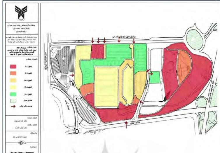
نقشه ۷: پهنه‌بندی نهایی پایانه غرب بر اساس شدت میزان خطر بر اساس کلیه معیارها و اولویت طراحی در بازه زمانی ۶ صبح تا ۶ عصر
