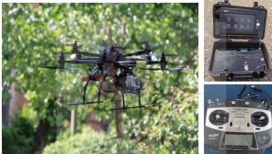
شکل ۱. بخش هوایی و زمینی عمودپرواز بدون سرنشین طیف‌نگار
