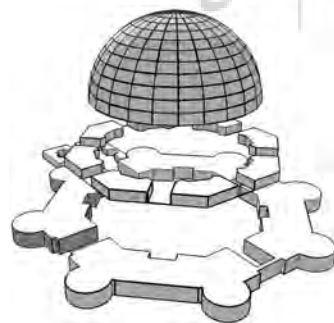
تصویر ۱۱: شماتیک از سه تراز بنای مقبره رکن عالم پلان همکف، تراز دوم و تراز گنبد
