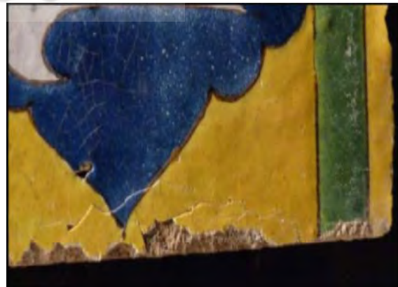
تصویر ۴- شبکه‌ی ترک‌ها در سطح لعاب کاشی تصویر ۵- پدیده‌ی پوسته‌شدن لعاب در حاشیه‌های کاشی
