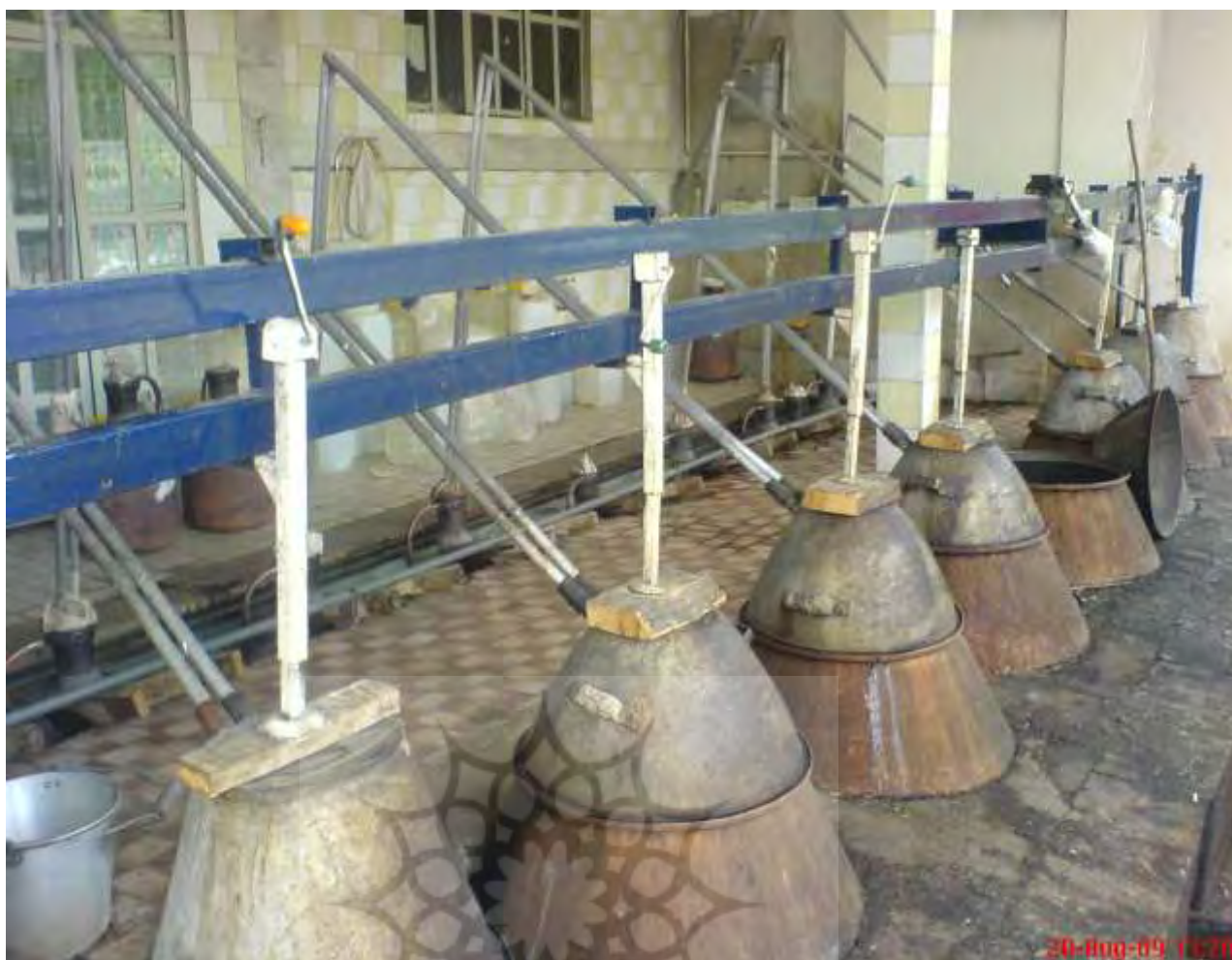
تصویر ۱۵- نوعی اهرم بستن درپوش دیگ. اکرم سادات نبی طباء. مرداد ماه ۸۸.
