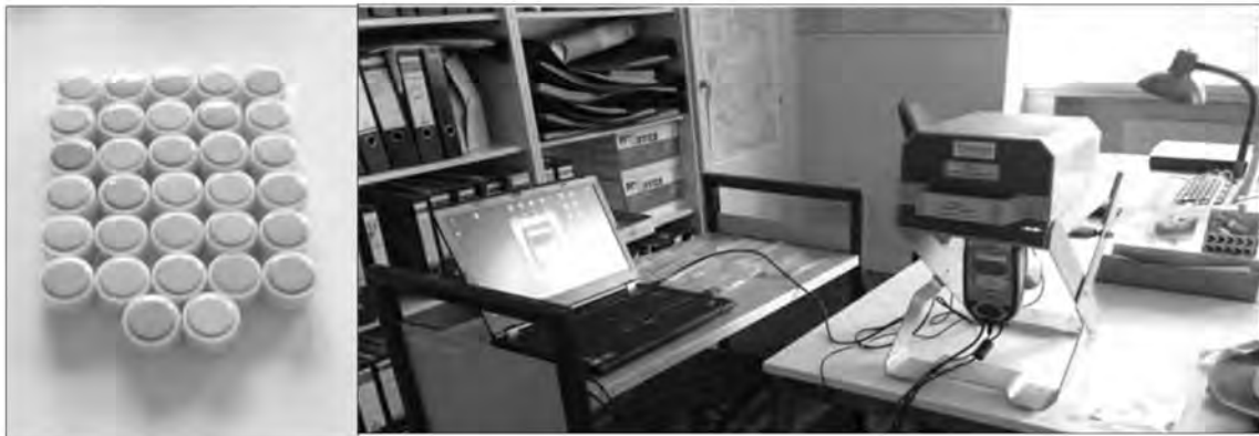
تصویر ۴: سمت راست دستگاه پرتابل در اتصال به محفظه محافظ برای نمونه‌های کوچک را نشان می‌دهد. سمت چپ نمونه‌های آماده پودر شده و در فریم و فویل پلی اتیلنی قرار داده شده است.
