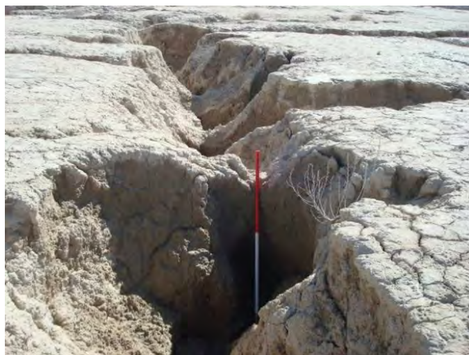
شکل ۲۱. پدیده تونلی شدن در اثر افزایش میزان املاح (به‌ویژه سدیم) در خاک (محدوده خندق‌های شماره ۱ تا ۳)
