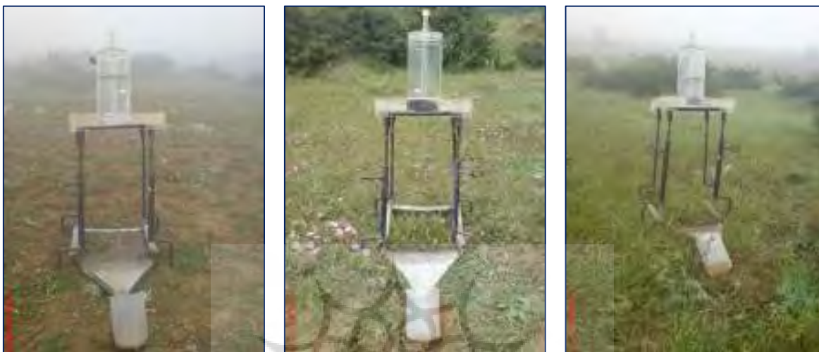
شکل ۲- چگونگی شبیه‌سازی باران در مقادیر مختلف پوشش گیاهی (به ترتیب از راست به چپ: حداکثر، متوسط و حداقل)
