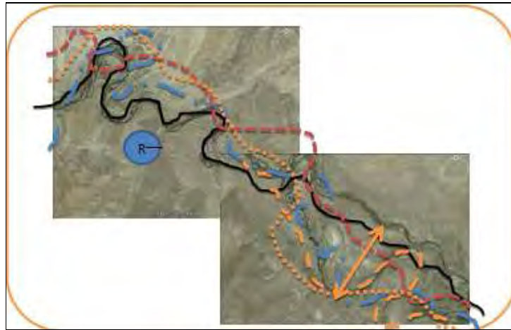
شکل (۲) تغییرات میزان سینوزیته و جابجایی در مسیر جریان آجی چای در طی زمان در بخش‌های میانی مسیر و اندازه گیری شعاع خمیدگی‌های مسیر
