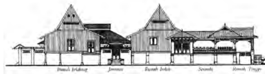
تصویر ۱: نمای خانه‌ای از گونه مالاکا با ستون‌های برآمده از زمین در جنوب مالزی (Wardi Sudin, 1987)
