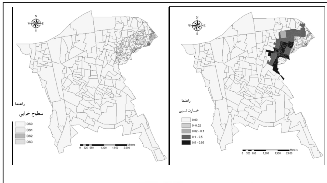
شکل ۹ سطوح خرابی مختلف در اثر سیل شکل ۱۰ خسارت‌های ناشی از سیل در منطقه مورد مطالعه
