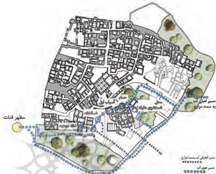
تصویر ۱۱: مسیر حرکت آب در داخل قلعه
