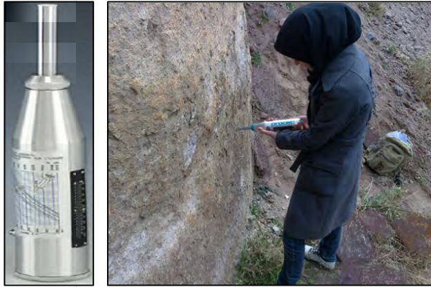
تصویر ۳: اندازه‌گیری سختی واجهشی سنگ با چکش اشمیت
