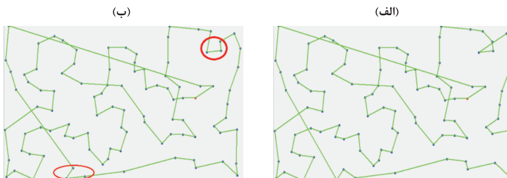
شکل ۶. بهبود جواب نهایی الگوریتم NN با استفاده از عملگر 2-opt (الف) جواب نهایی NN (ب) بهبود جواب NN
