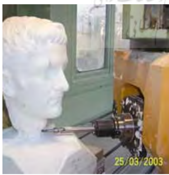
ت. ۴- تراشیده شدن سنگ به وسیله ماشین تراش (CNC)
