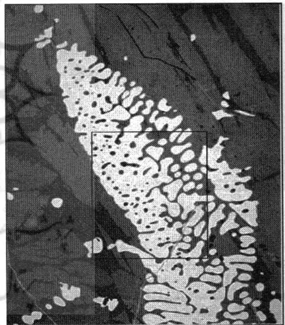
تصویر ۲. نمایی از مگنتیت به رنگ روشن با ساختار دندریتیک در یک مخلوط فایالیتی به رنگ تیره.
