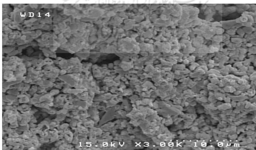
شکل ۴: سطح مقطع آند تک سل با میکروسکوپ SEM با بزرگنمایی ۳ هزار برابر
