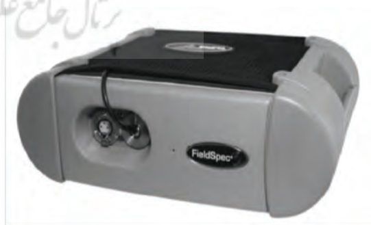
شکل ۳. دستگاه فیلداسپیک ۳ (سمت راست) و ابزار تکمیلی Contact probe (سمت چپ) (ابزار طیف‌سنجی موجود در گروه سنجش از دور و GIS دانشگاه شهید چمران اهواز)
