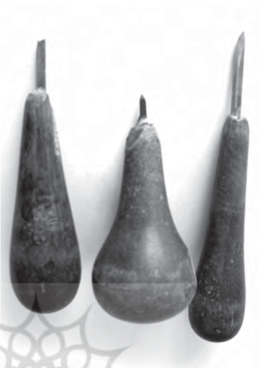
تصویر ۵- قلم فولادین برای حکاکی مُهرهای برنجی (فلزی)، قدمت قاجاریه، مجموعه خاندان حمیدی حکاک شیرازی، ماخذ: نگارندگان
