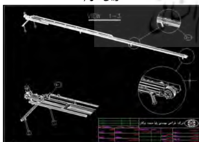
تصویر ۲-د. تصویری از محل اتصال و قرارگیری تسمه‌ها روی کانوایر
