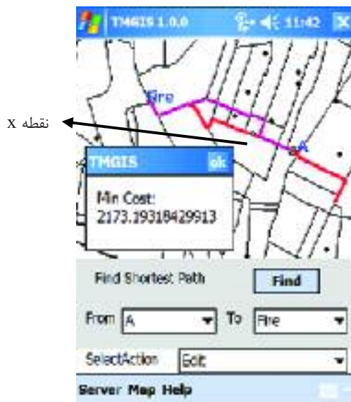
شکل ۷. کوتاه‌ترین مسیر ممکن (مسیر بنفش) که از نقطه X (انسداد راه) نمی‌گذرد
