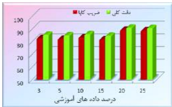
شکل ۷. دقت کلی و ضریب کاپا در حالت استفاده از درصد داده های آموزشی که برای آموزش الگوریتم SOM به کار برده می شود.
