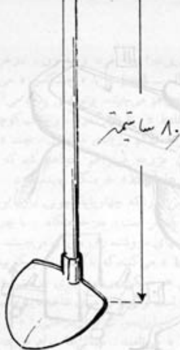
«بلو - balu» با دستهٔ چوبی و تیغهٔ آهنی، وسیله‌ئی برای جوی‌گندن و مرمت نهر
