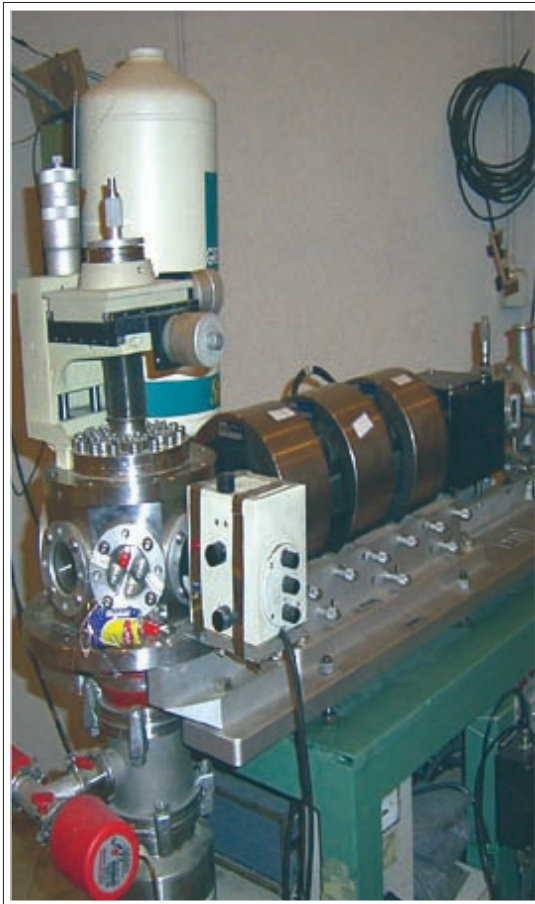
ت ۱: دستگاه تولید باریکه میکرونی پروتون و آشکارساز اندازه‌گیری پرتو X .
