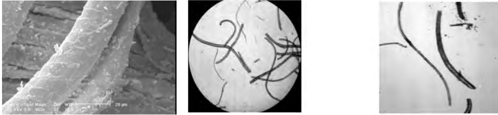
تصویر ۱۷- اختلاف قطر لیف های کرم و قهوه ای. عکس های میکروسکوپی از الیاف پروتئینی با میکروسکوپ دو چشم و الکترونی SEM. فلس های مشخصه لیف پشمی به خوبی در تصاویر دیده می شوند. ماخذ: (عکس از هاله زرینه و آزمایشگاه SEM دانشگاه تربیت مدرس).
