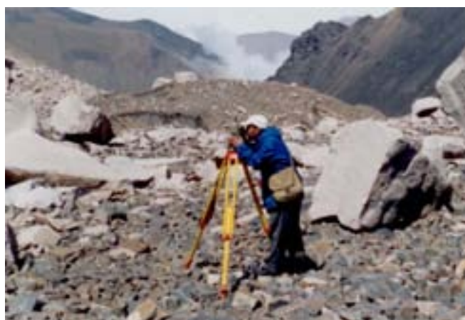
شکل ۹. اندازه‌گیری در امتداد مقاطع با دوربین تئودولیت T-16
