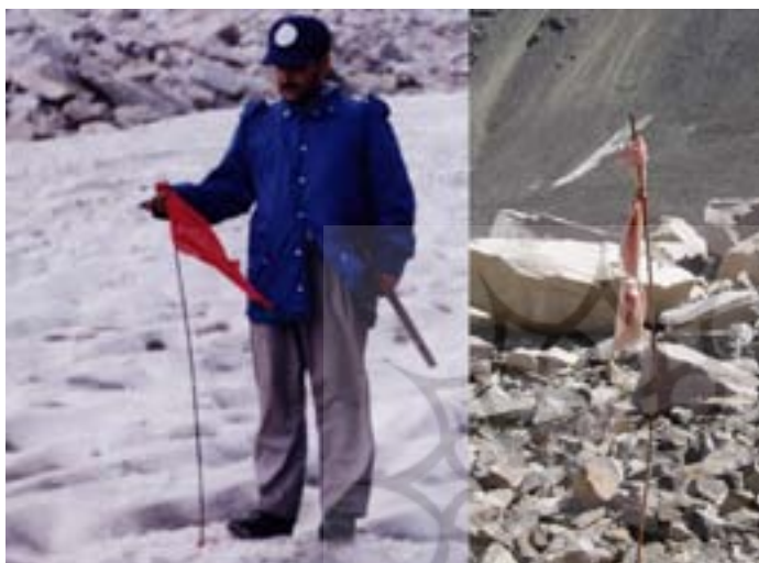
شکل ۱۰. نمونه‌ای از پلاک و پرچم علامت‌های نصب‌شده روی زبانه‌ها عکس سمت چپ، سال ۱۳۷۹ در حال نصب میله شاخص روی مقطع شماره ۳ (خروجی سیرک تخت سلیمان). عکس سمت راست، سال ۱۳۸۲ میله شاخص نصب‌شده روی مقطع شماره ۱ (زبانه یخچالی علم‌چال).
