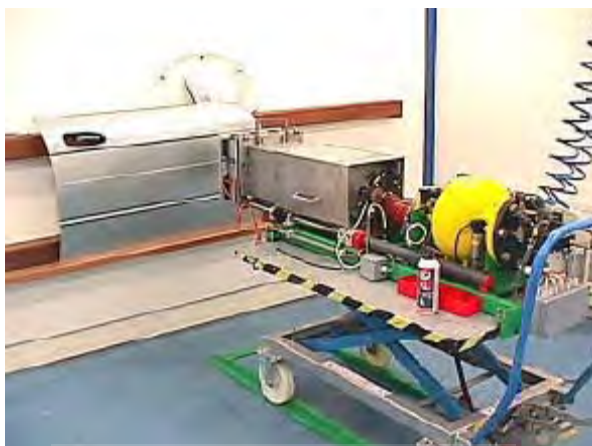
شکل دوازده: تفنگ بادی برای آزمون ضربه دینامیکی پنل خودرو
