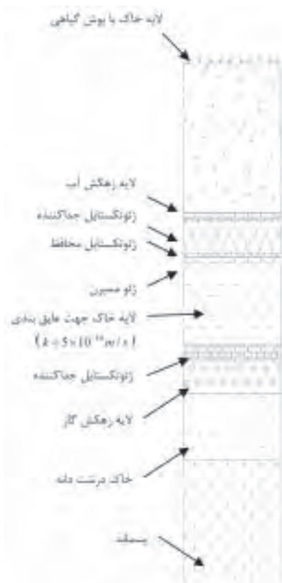
شکل ۹- جزئیات عایق بندی پوشش
