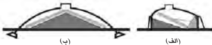
تصویر ۷- ارتباط بین فرم نوع عملکرد و سازه: (الف) نوار نقاله خود نگهدارنده، (ب) نوار نقاله نگهداشته شده توسط دیوار با جرثقیل با بازوی متحرک. ماخذ: (Falconer and Drury 1975)
