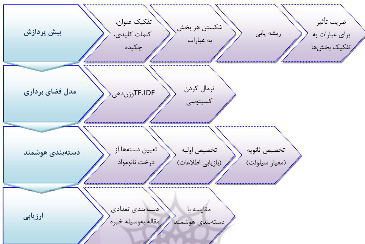
شکل ۱) نمودار جریان روش طبقه‌بندی بدون ناظر متون بر پایه معیار سیلوئت - SUTC
