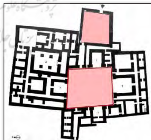
تصویر ۵. سازمان فضایی میانسرا در سروستان (بالا) و کاخ آشور (پایین). مأخذ: پیرنیا، ۱۳۸۲.
